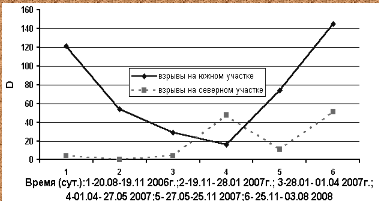
Рис.3. Распределение во времени поглощенной сейсмической энергии в результате отработки массива технологическими и массовыми взрывами.
